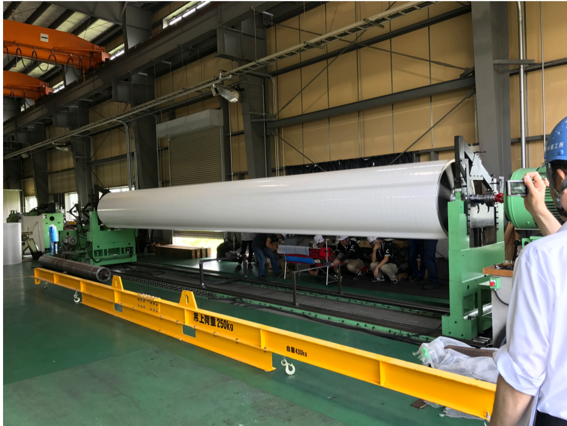
写真2 円筒翼の回転試験
